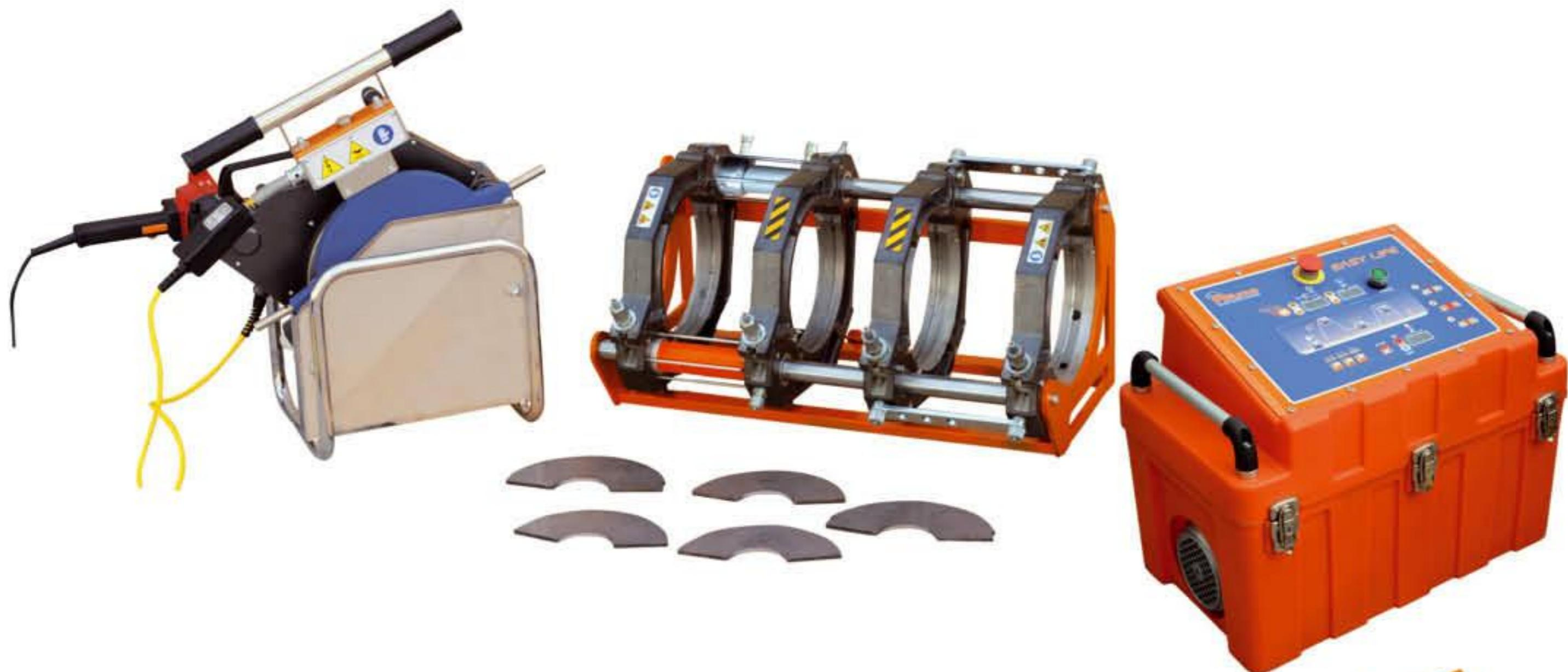
**BASIC EASY LIFE** – это новый гидроагрегат для машин серии BASIC для сварки в полуавтоматическом режиме.
