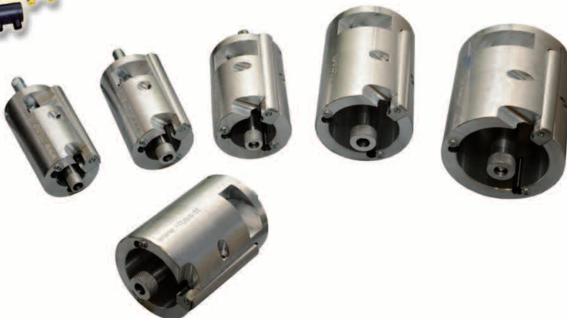
**TURBO** – это новая разработка завода для быстрой зачистки внешней поверхности трубы и снятия фаски перед сваркой. Каждая из насадок предназначена для одного диаметра. Линейка инструментов TURBO включает в себя насадки для работы с трубами от 20 до 63 мм в диаметре, с параметром SDR от 6 до 11.
