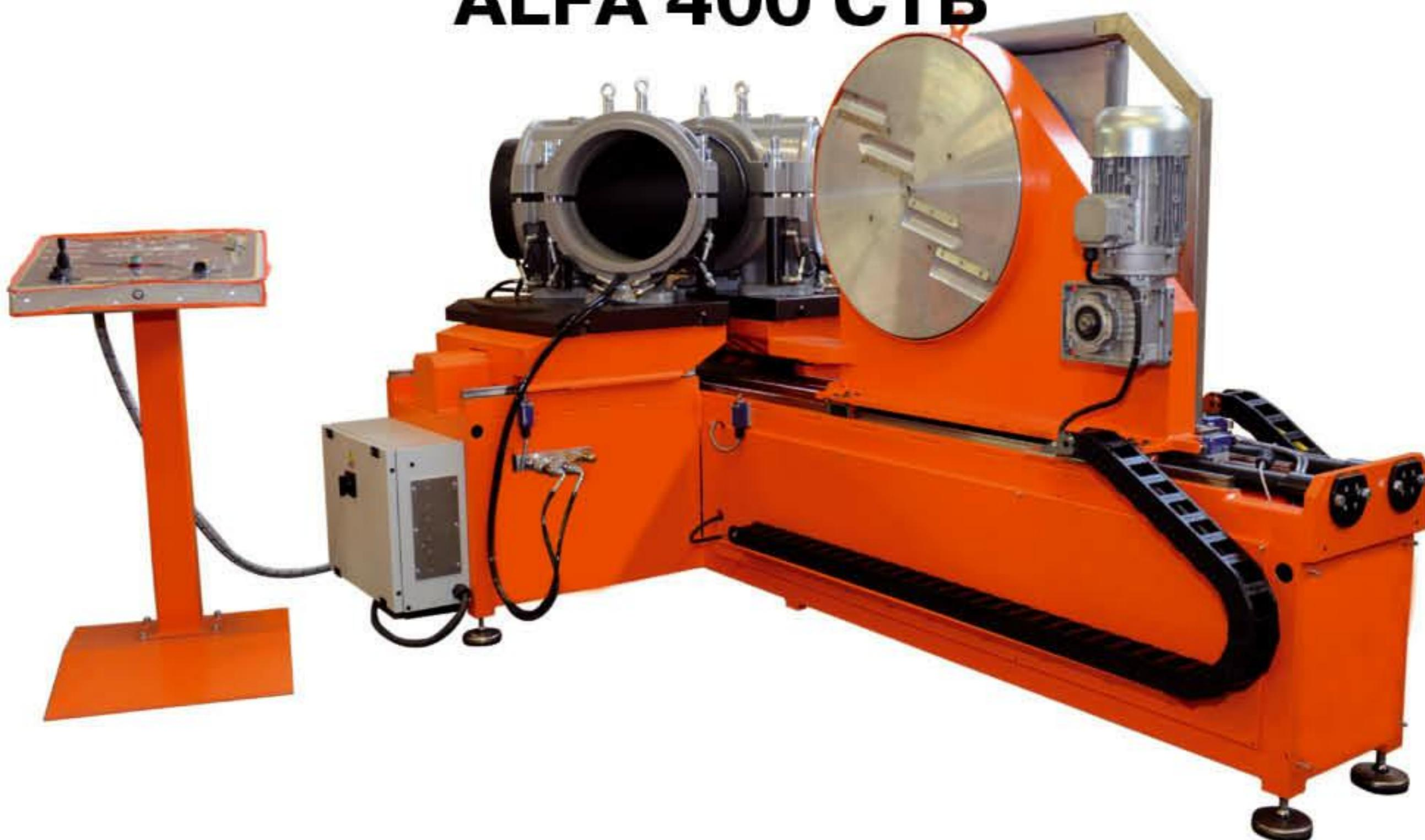
Цеховая сварочная машина для стыковой сварки сегментных **отводов** (до Ø 400 мм), **Y-образных фитингов, тройников и крестовин** (до Ø 355 мм) с помощью специальных зажимов. Зажимы для отводов и Y-образных фитингов открываются, закрываются и фиксируются с помощью гидравлического привода; зажимы тройников и крестовин открываются и закрываются оператором вручную.
